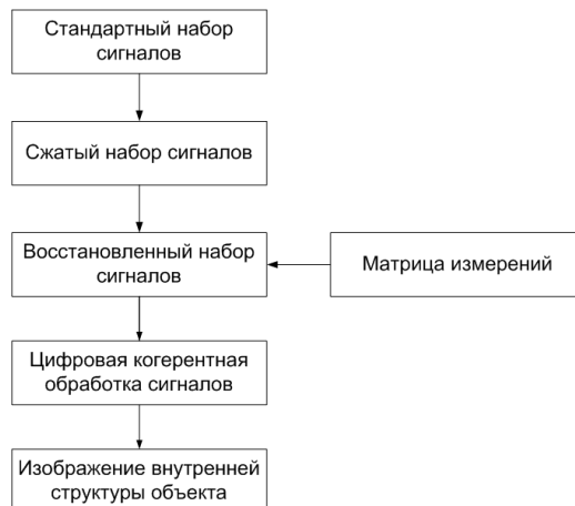
Рисунок 5 – Преобразование набора сигнала в процессе проведения анализа
