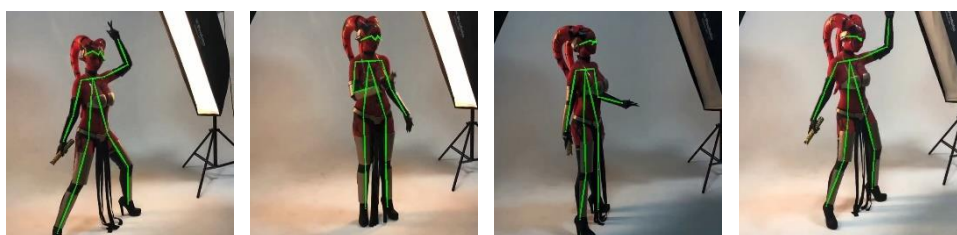
Рис. 1. Пример построения скелетона человека с применением AlphaPose
