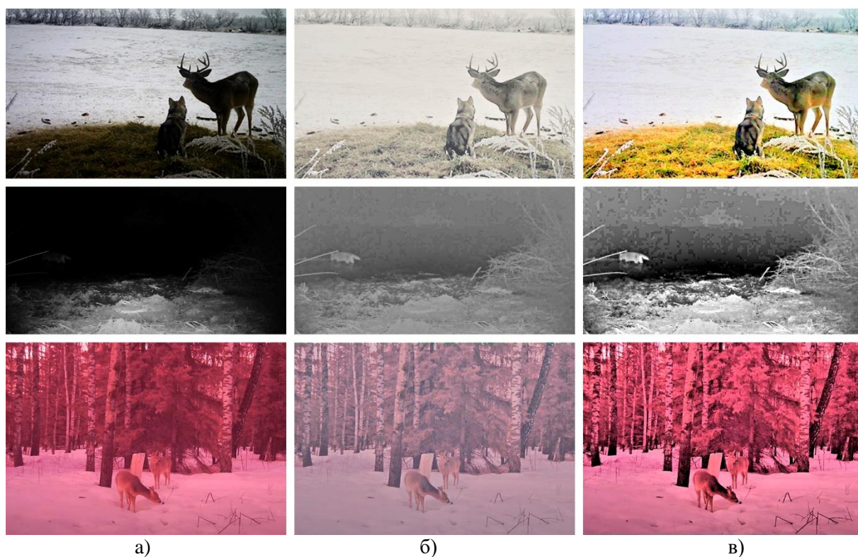
Рисунок 2 – Пример применения алгоритмов: а) оригинал; б) MSRCR; в) MSRCP
