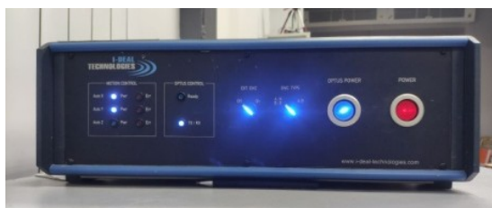
Рисунок 1 – Блок многоканальной ультразвуковой электроники Optus
